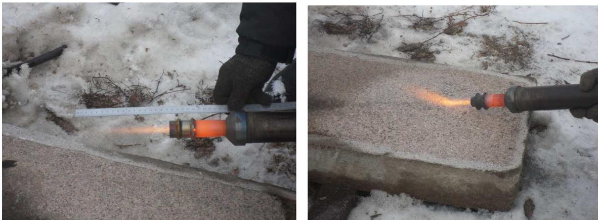
Рис. 2. Испытания термоинструмента с газодинамическим насадком
